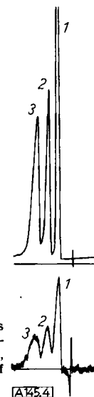
Abb. 4. Radiogaschromatogramm eines Gemischs von Äthanol- ^3\text{H} (1), Brenzkatechin- ^3\text{H} (2) und Hydrochinon- ^3\text{H} (3). Oben Gaschromatogramm ( 15\text{ }\mu\text{l} , 0,75\text{ atm H}_2 , 210^{\circ}\text{C} , Säule 1,50\text{ m} , Siliconfett auf Celite; 150\text{ mA} , 10\text{ mV} ); unten Aktivitätskurve
